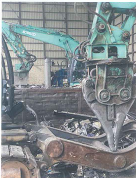
▲同社解体現場のニブラー。スクラップの現場では威力を発揮する
