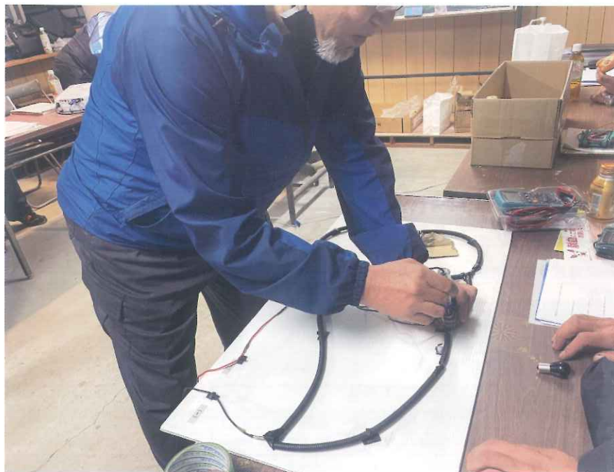
▲サーキットテスターを使って配線模型の故障箇所を探す
