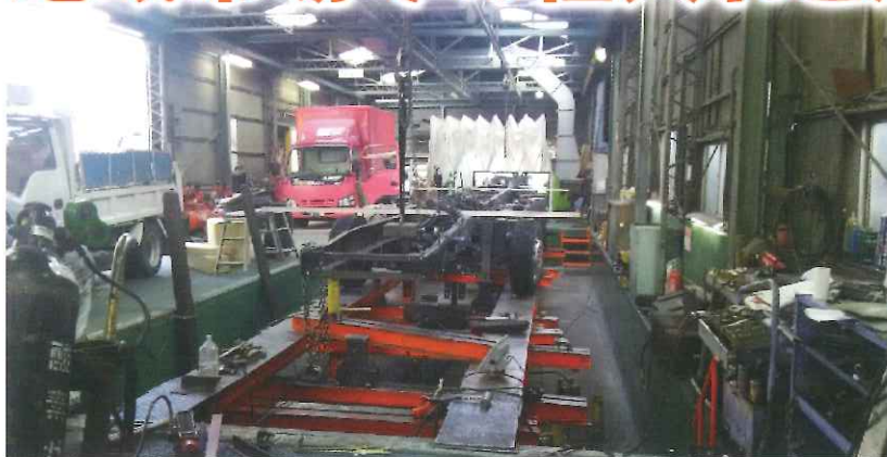
▲大型トラックの修理にはリサイクル部品が大活躍する。写真はトラック修理のためのフレーム修正機
